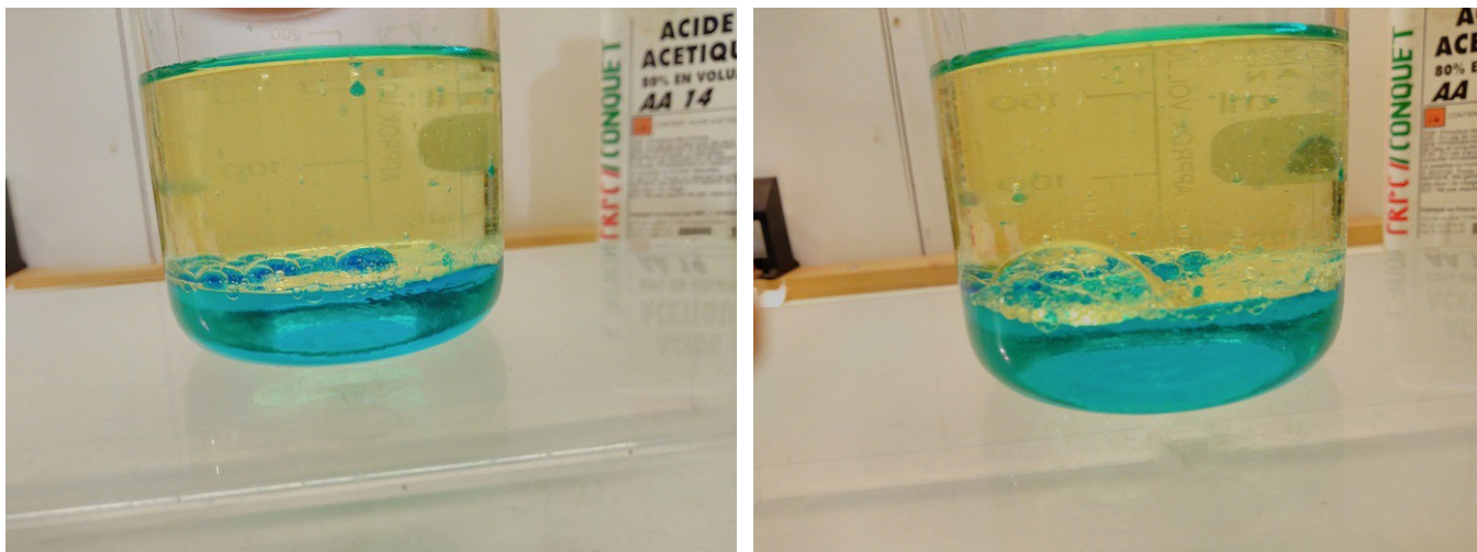
Figure 3 : formation de bulles plus importantes, formées d'une phase gazeuse de gaz carbonique entourant une phase liquide de bicarbonate de soude
