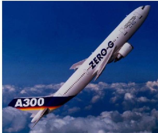
figure 2 - avion A300-zéroG. Il permet d'entraîner les cosmonautes en apesanteur pendant 25 secondes environ (photo © CNES)
