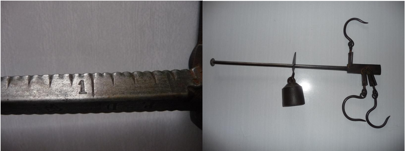
photo 2 – configuration 1 de la balance romaine : portée maximale 7 kg, graduation : 1 kg pour 5,5 cm ; la masse à peser doit être accrochée au crochet le plus à droite, où OB = 5,5 \text{ cm}
