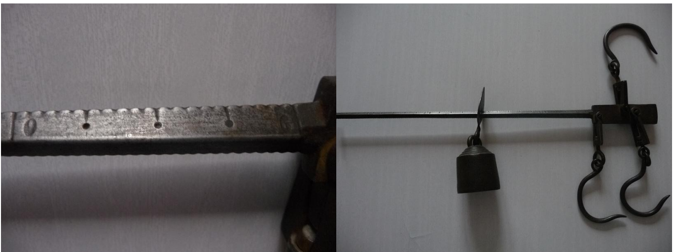
photo 3 – configuration 2 de la balance romaine : portée maximale 28 kg, graduation : 1 kg pour 1,5 cm ; la masse à peser doit être accrochée au crochet le plus à droite, où OB = 1,5 \text{ cm}
