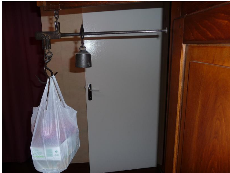
photo 1 – balance romaine pesant un sac de 2 kg ; on voit que ni la masse coulissante, ni l'objet à peser, ne sont placés sur la tige
