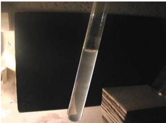
*après avoir incliné le tube à essai de façon à faire passer l'eau de chaux dans le tuyau, et l'avoir bien secoué, l'eau de chaux se trouble : elle a réagi avec le gaz carbonique présent dans le tuyau et le tube*
