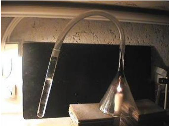
*la vapeur de la bougie enflammée entre dans le tube à essai contenant de l'eau de chaux*
