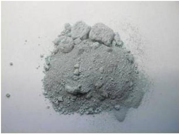
*sulfate de cuivre après combustion de la bougie : il a viré au bleu, c'est du sulfate de cuivre hydraté par la vapeur d'eau*
