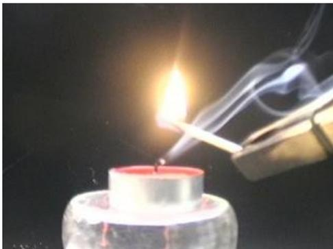
*on rapproche encore la flamme de l'allumette ; noter la présence encore de la vapeur de cire condensée*
