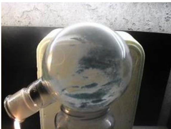
*après la combustion de la bougie, dépôt de suie à l'entrée du ballon, et le sulfate de cuivre déposé sur les parois a viré au bleu : signe de présence d'eau*
