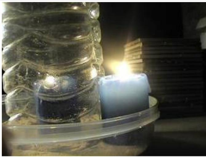
*lorsque les ouvertures sont situées en bas et en haut de la bouteille, sur une même verticale, l'air circule de bas en haut : une flamme près du trou inférieur est aspirée*
