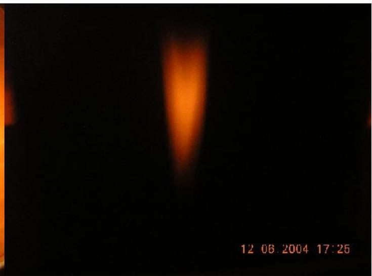
*Image réelle de la flamme sur l'écran formé du papier calque transparent*
