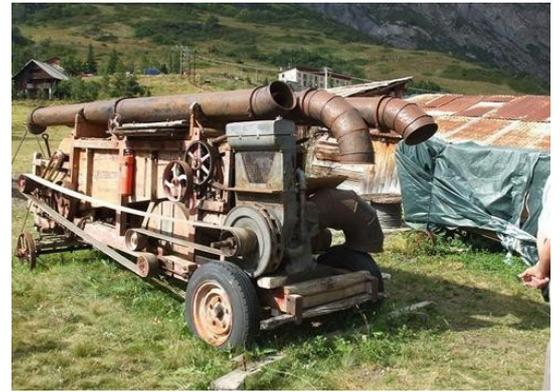
*la batteuse mécanique*
