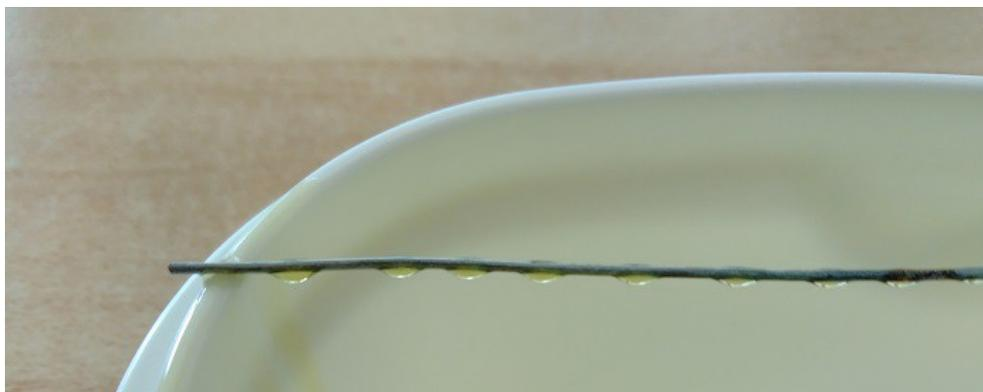
Figure 4 : formation de perles axisymétriques avec de l'huile d'olive
