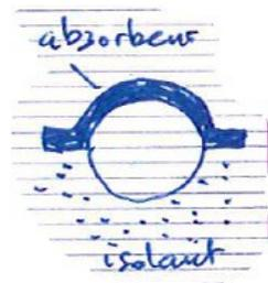
figure 3 – augmenter la surface de contact entre l'absorbeur et les tuyaux du fluide caloporteur
