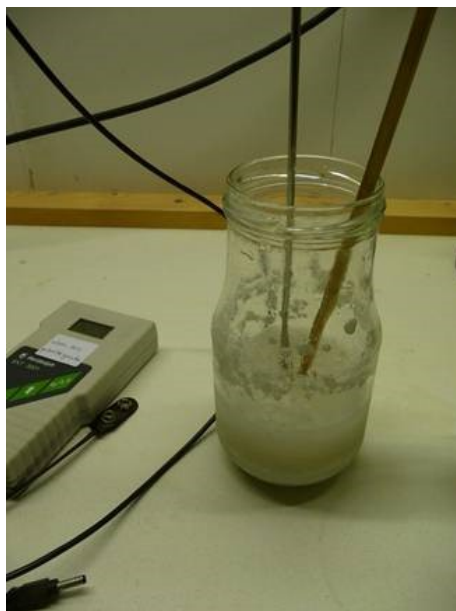
photos 0 : mélange réfrigérant obtenu avec des sels de chlorure de calcium hydraté et de la glace pilée
