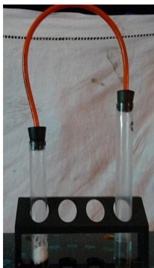
photo 2 : montage simple pour récupérer le CO 2 à partir de la réaction du calcaire et de l'acide chlorhydrique
