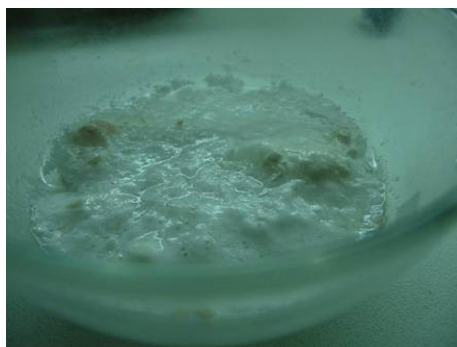
photo 1 : réaction du calcaire (coquilles d'œuf) et de l'acide chlorhydrique, avec formation de mousse
