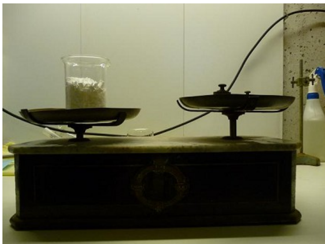
figure 5 – pesée du chlorure de calcium anhydre (1 mole)
