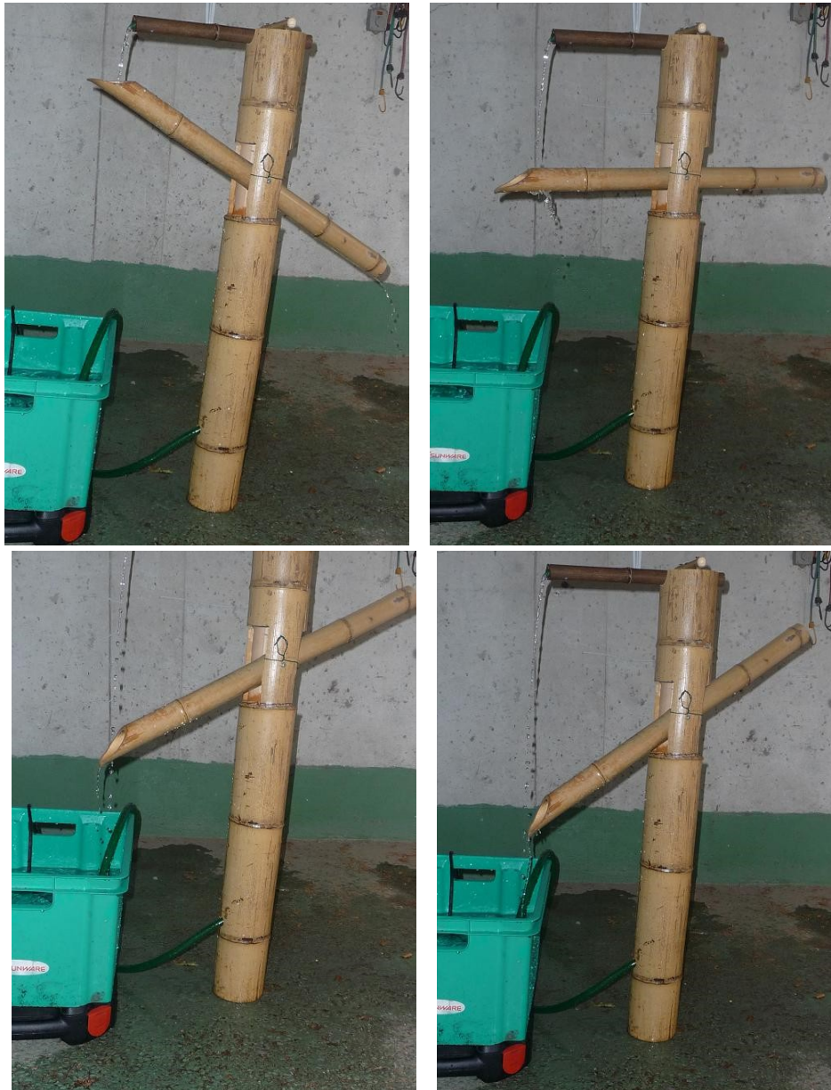
figure 4 – montage provisoire pour tester la fontaine et la position relative de la pompe et du robinet supérieur. Les photos montrent une phase où le tube mobile bascule
