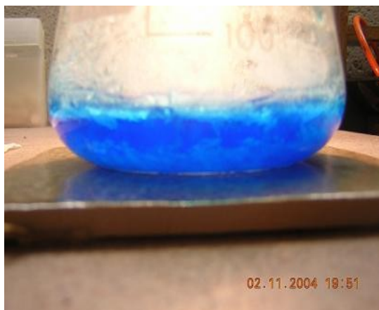
cristallisation du sulfate de cuivre pendant le refroidissement d'une solution saturée
