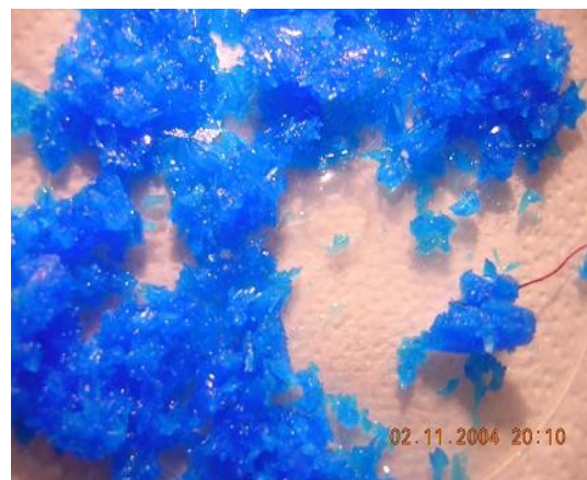
cristaux de sulfate de cuivre après refroidissement d'une solution saturée - à droite, les cristaux se sont agglomérés sur un fil qui trempait dans la solution
