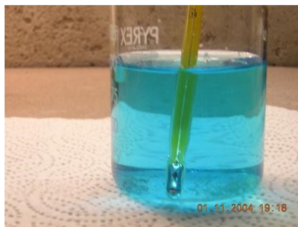
propriété exothermique de la dissolution et de la réhydratation du sulfate de cuivre anhydre dans l'eau
