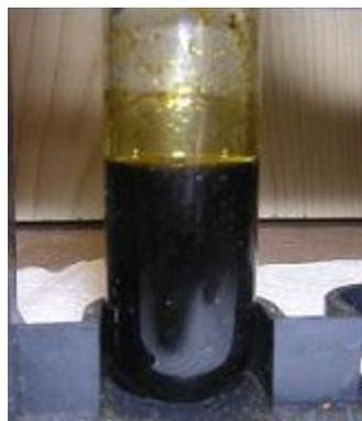
*attaque du clou en fer par l'eau régale à froid: réaction vive*      *en quelques jours le clou a disparu et l'eau régale a pris une couleur rouille*
