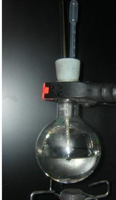
*photo 2 : un bouchon (pipette en plastique) ferme le ballon contenant de l'eau en ébullition, on constate une augmentation de la température au-delà de 100°C*
