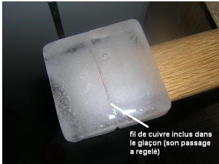
photo 7 : constat du regel à la traversée du glaçon par le fil de cuivre
