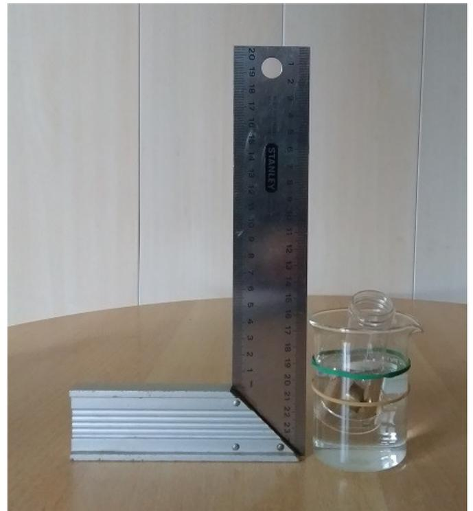
(b) nouvelle hauteur d'eau  $h_1$  après plongement de l'éprouvette contenant la masse de 10g (repère élastique vert)
