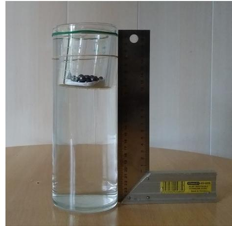
(b) nouvelle hauteur de la surface libre  $h_1$  apr s plongement du b cher contenant les 35 billes m talliques : rep r e par un  lastique vert
