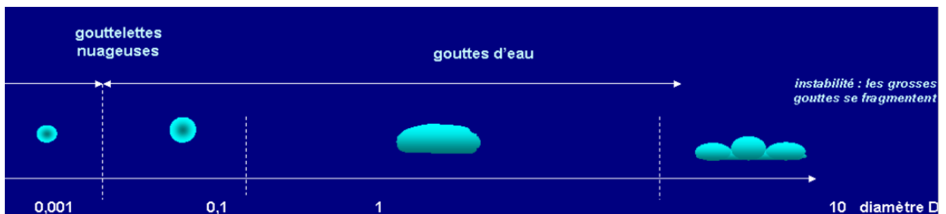
figure 7 – taille (diamètre D en mm) et formes des gouttes et gouttelettes d'eau : jusqu'à D = 1 mm les gouttelettes sont sphériques, au-delà elles se déforment. Lorsque la taille critique de 10 mm est atteinte elles sont en instabilité hydrodynamique, la résistance due à l'écoulement dans l'air ambiant surpasse les forces de cohésion surfacique et la goutte se fragmente en gouttelettes
