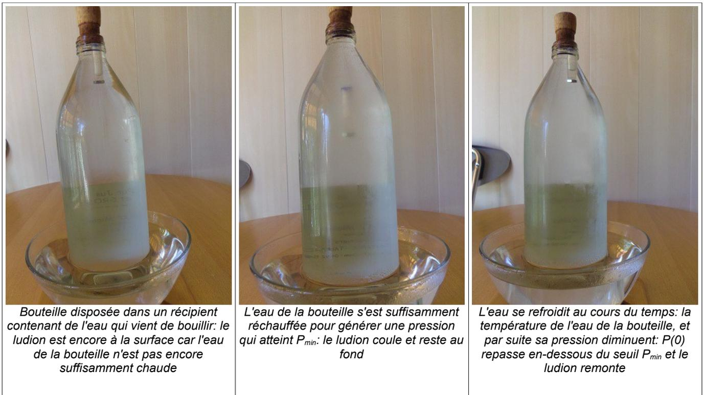
Figure 9 - Augmentation de la pression par réchauffement
