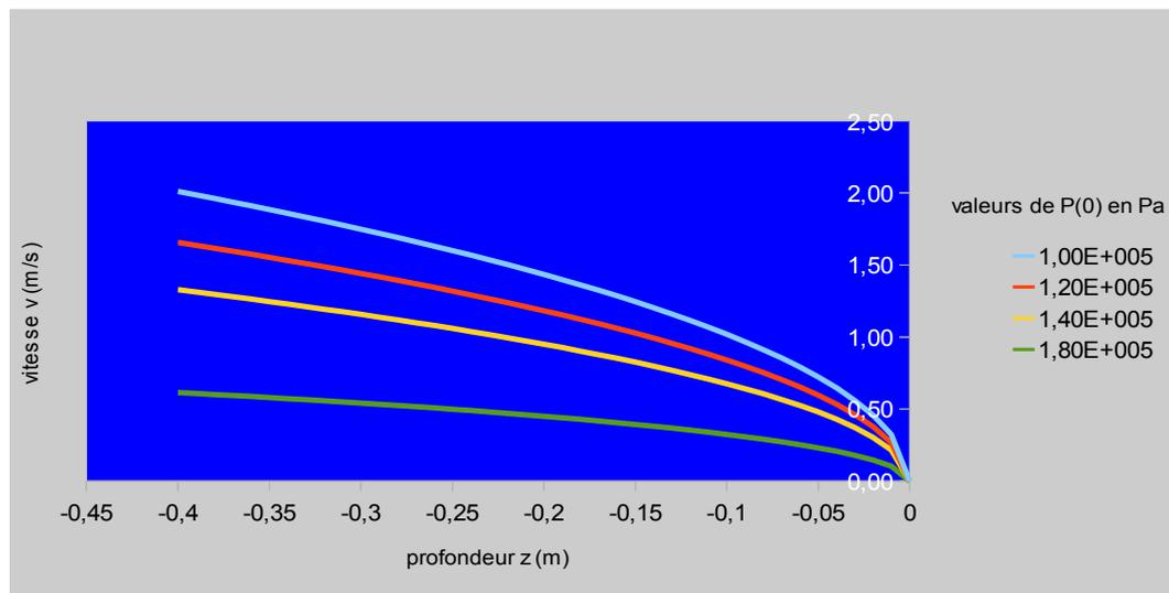
figure 4 - évolution de la vitesse d'immersion  $v(z)$  en fonction de la profondeur  $z$  pour différentes valeurs de la pression appliquée au liquide  $P(0)$
