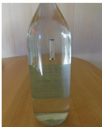
(e) - La pression  $P(0)$  est diminuée et devient plus faible que  $P_{min}$  (bouchon légèrement retiré): le ludion remonte
