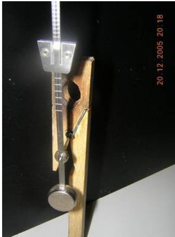
photo 4 – montage bricolé pour évaluer la période du pendule composé du métronome sans le ressort
