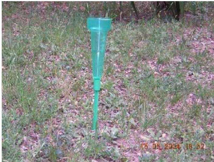
La forme de sa génératrice obéit à la relation:  $r(h) = ah + b$  avec  $b = r(0) < d/2$  pour  $h = 0$  (fond plat), et  $a = (d/2 - b)/h_0$ . La loi de graduation de la hauteur lue  $H(h)$  est obtenue par intégration de (6):
