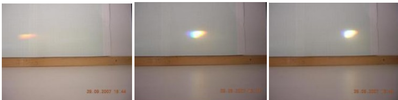
Déplacement du spot suite à la rotation du prisme, depuis la position correspondant à l'incidence initiale i_0 (photo de gauche), jusqu'à celle correspondant à la déviation minimale (photo de droite), photo du milieu position intermédiaire. L'appareil photo étant fixe et le champ étant le même, ces trois photos permettent de comparer les positions (photos : F. Élie)
