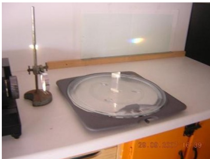
Dispositif « amélioré », la distance entre l'écran et le centre du prisme sur le disque tournant est h = 33,5 cm (photo : F. Élie)
