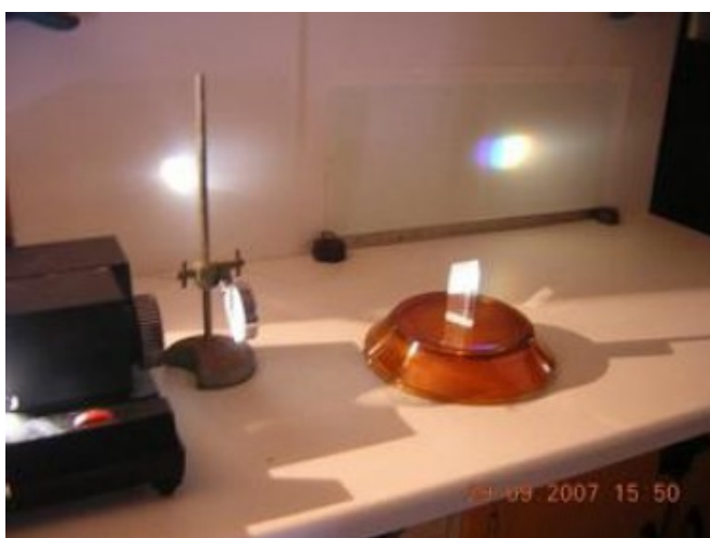
Dispositif sommaire employé pour la décomposition de la lumière blanche d'un projecteur de diapositives, et spectre visible obtenu sur l'écran (photos : F. Élie)
