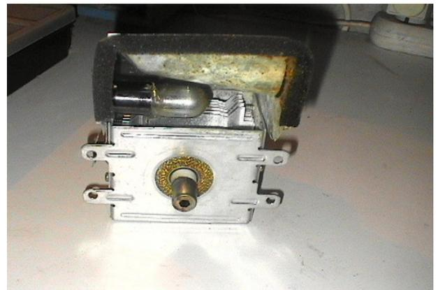
Figure 13 – magnétron démonté, avec la lampe interne (photo : F. Élie)
