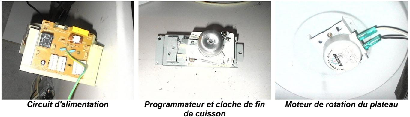
Figure 20 – circuit d'alimentation, programmeur, moteur du plateau tournant
