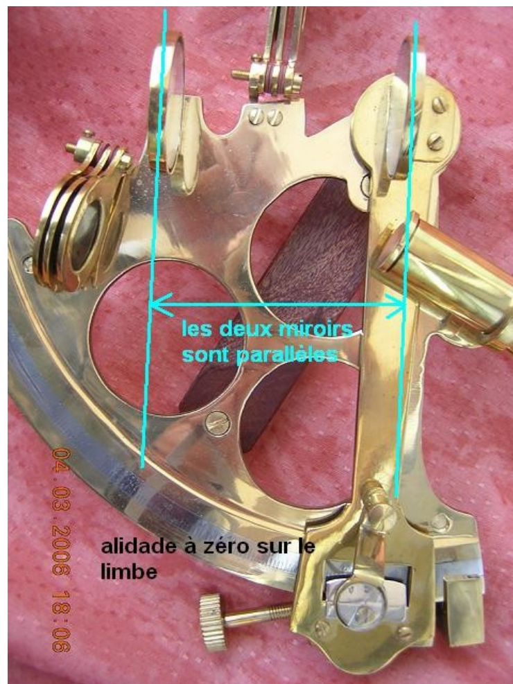
photo 3 : parallélisme des miroirs pour alidade à zéro
