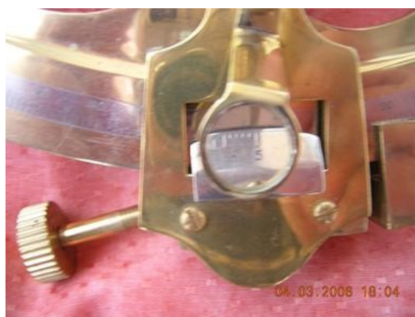
photo 4 : fenêtre de lecture et sa vis de réglage
