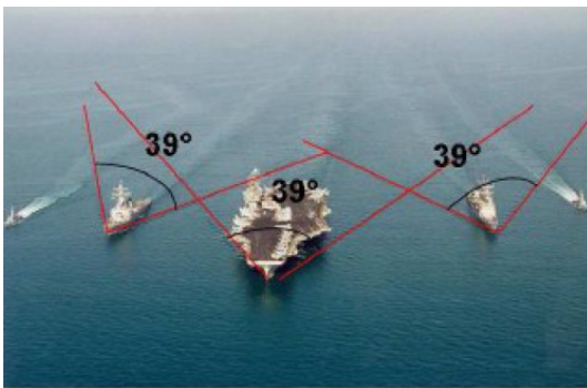
Photo 1: le porte-avions Clémenceau et ses navires escorteurs créent un sillage identique d'ouverture 39° (photo Marine Nationale)
