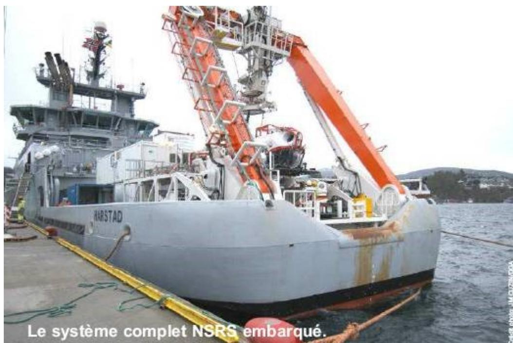
*le système NSRS embarqué sur la plage arrière d'un navire de soutien, avec le portique
