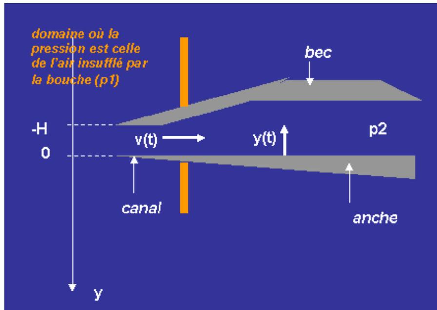
principe d'un bec à anche de clarinette
